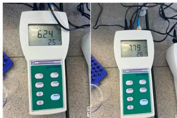
Рисунок 9 – Измерение кислотности с помощью pH-метра
