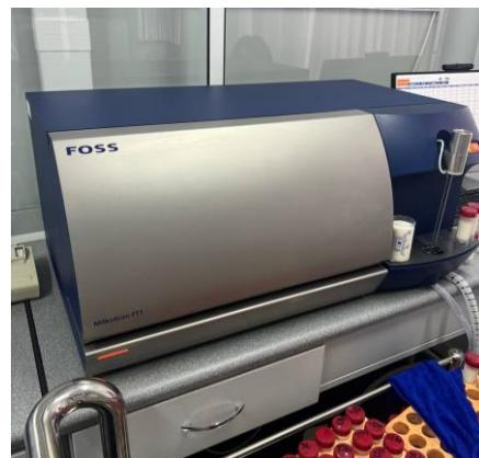
Рисунок 8 – Проведение физико-химического анализа на MilkoScan FT1
